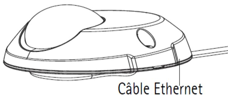
2 Connecter l'extrémité du câble Ethernet de la caméra sur le boîtier POE puis du boîtier POE sur la box ADSL où est branchée la box TaHoma.
