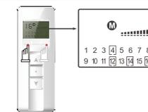
Appuyez une autre fois sur la K1 ou la K3 pour programmer la position des moteurs, par exemple, jusqu'à 100%.
