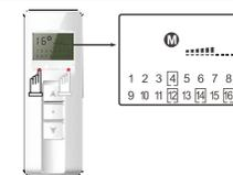
Dans ce mode-là, faites un appui bref sur la touche K1 ou la K3, les moteurs choisis marchent automatiquement à la position enregistrée.
