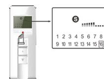
Appuyez brièvement sur la K2 pour activer le mode de synchronisation du contrôle simple (S).
